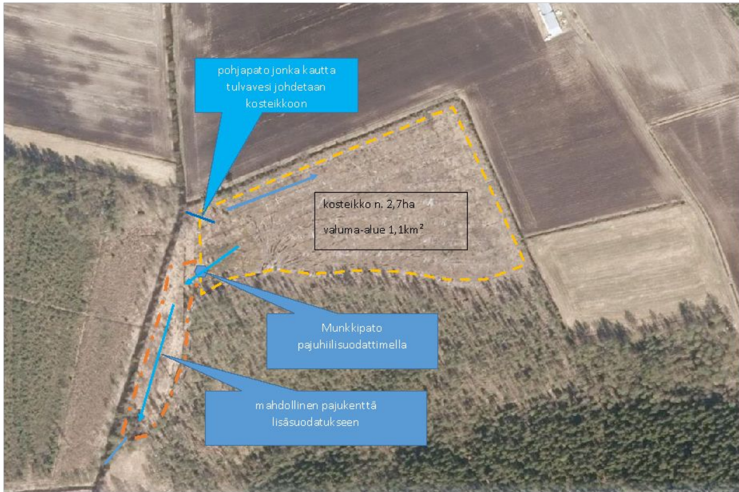
Kosteikon periaatekuva pajuhiilisuodattimella ja pajukentällä. Ortokuva Karttaikkuna, muotoilu Ympäristöpalvelu S.Kauhanen
